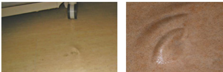
独自試験による検証の結果、キャスターにロックを掛けた状態での人の乗り降りによって繰り返生じる寸動、あるいはベッドの移動旋回等によるねじれの力の発生など、さまざまな要因が複合的に作用したものと考えられます。
